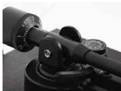
Ramię wyposażono w dwie podstawowe regulacje – siły nacisku igły oraz anti-skatingu.
