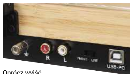
Oprócz wyjść analogowych (RCA), które mogą wysłać sygnał przed lub po korekcji phono, jest też wyjście USB (przeznaczone do podłączenia komputera).
