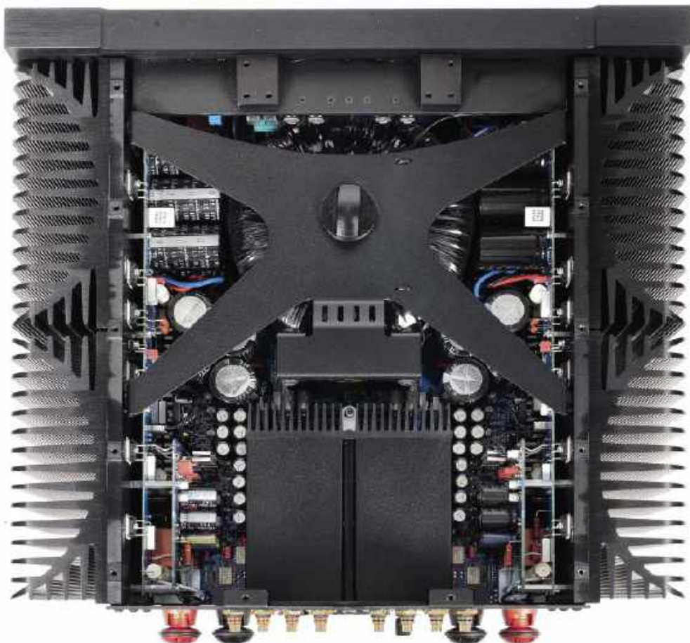
Konstrukcję Diablo 333 determinują końcówki (bardzo wysokiej) mocy, wymagające miejsca, radiatorów i wydajnego zasilacza.
