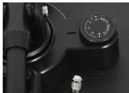
Anti-skating ustawiamy popularnym i wygodnym pokrętełkiem połączonym z mechanizmem sprężynowym.
