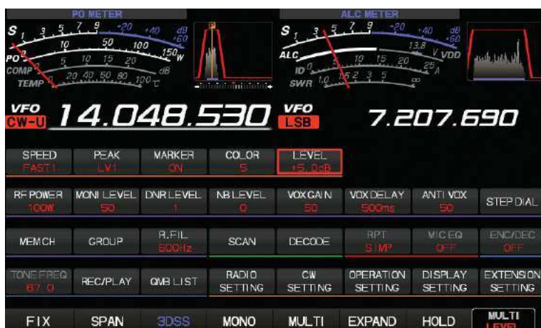
Rys. 5. Po naciśnięciu klawisza FUNC pod ekranem wyświetlany jest najwyższy poziom menu. Przycisk MULTI powoduje otwarcie okna z parametrami wybranego punktu lub z jego podpunktami
