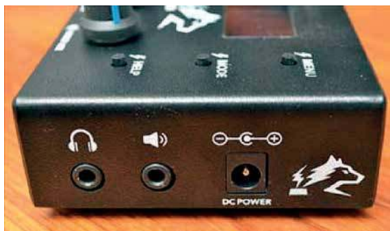
Fot. 2. Widok z prawej strony. Napięcie zasilania wynosi 7–18 V
