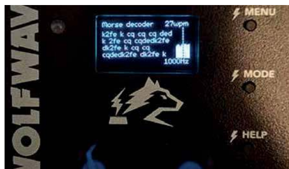
Fot. 3. Dekoder telegrafii jest dostosowany do szybkości telegrafowania 5–40 słów/min
