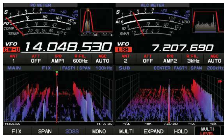
Rys. 3. Widok jak z rysunku 2, ale po dodaniu wskaźnika perspektywnicznego dla pomocniczego odbiornika, który może być dostrojony do innego pasma, nastawiony na odbiór innej emisji i połączony z inną anteną niż główny. Wskaźniki obu odbiorników można też umieścić jeden nad drugim
