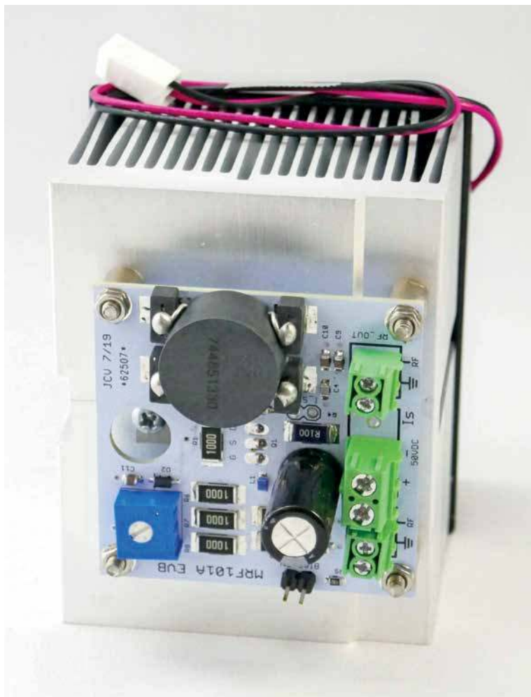
Wzmacniacz z MRF101 zamontowany na radiatorze
