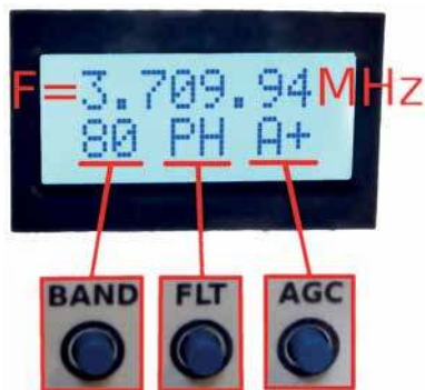
Rys. 3. Wykorzystanie wyświetlacza LCD i przycisków sterujących
