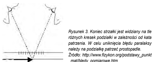
Rysunek 2. Widoczny błąd odczytu, czyli: (a) błąd paralaksy polega na tym, że oko odczytując pod złym kątem dane z miernika, (b) widzimy wskazówkę przyrządu na tle niewłaściwej podziałki. Źródło: http://www.fizykon.org/podstawy_punkt_mat/blady_pomiarowe.htm , http://nasze-wiatrowki.pl/printview.php?t=211&start=0
