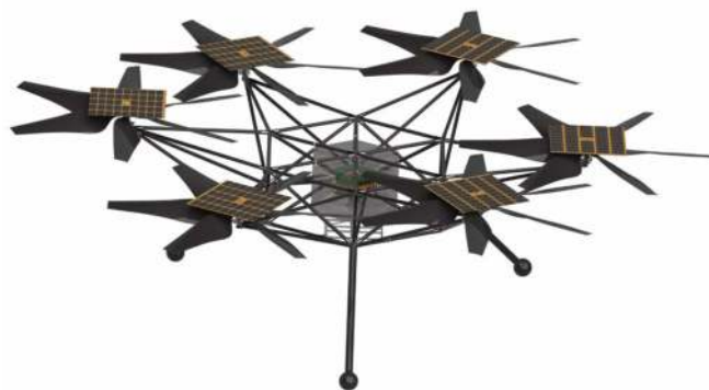
Mars Chopper – koncepcja sześciolotowego drona rozmiarów SUV-a zdolnego do przenoszenia do 5 kg ładunków na odległość do 3 km. Naukowcy testują go w kalifornijskiej Dolinie Śmierci.
