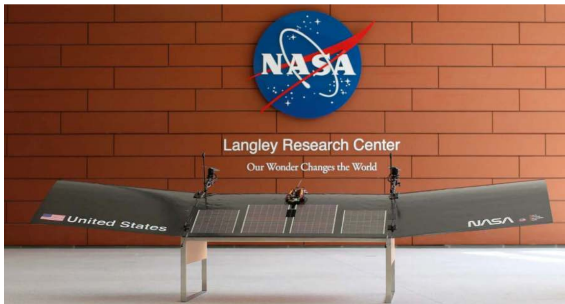
Model „skrzydlatego” drona Mars Electric Reusable Flyer. To kolejna z propozycji przedstawionych przez naukowców z myślą o misjach marsjańskich
