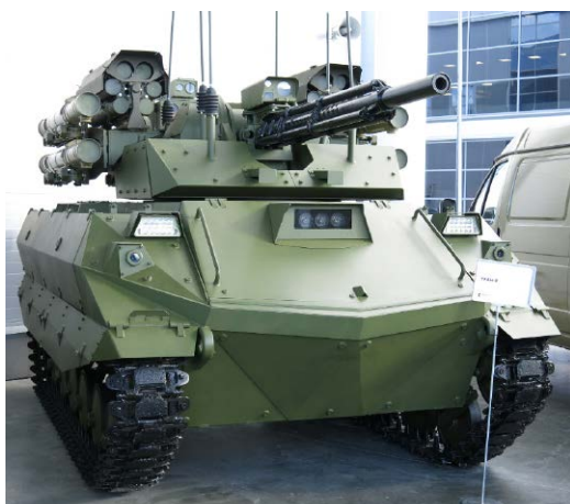
Uran-9 – widoczna armata 30 mm 2A72, wyrzutnia rakiet przeciwpancernych Ataka i masywna sylwetka (12 ton). W warunkach bojowych zasięg łączności wyniósł 300 m zamiast deklarowanych 3 km, co czyniło pojazd praktycznie bezużytecznym. Źródło: Boevaya mashina – Praca własna, CC BY-SA 4.0, https://commons.wikimedia.org/w/index.php?curid=72788153
