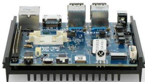
Fotografia 9. Komputer SBC typu ODROID-N2+
