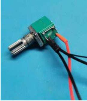
Fotografia 5. Podłączenie przewodów do potencjometru/przełącznika
