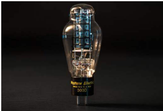
Fotografia 2. Lampa elektronowa mocy stosowana we wzmacniaczach audio
