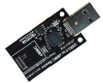
Fotografia 2. Programator do modułów z pamięcią eMMC
