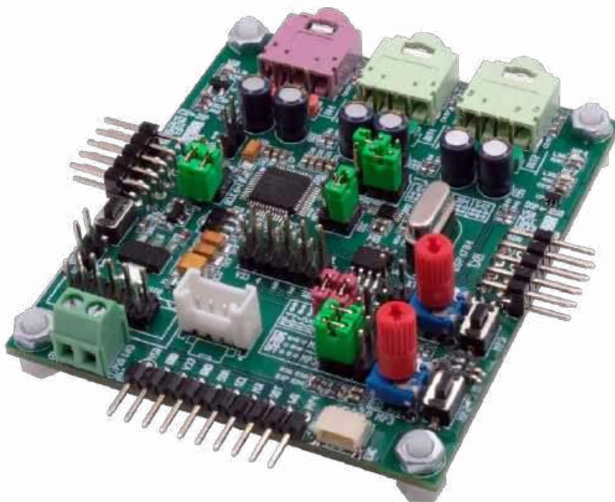
Fotografia 1. Wygląd płyty głównej zestawu DSP1701A_DSP_MK2
