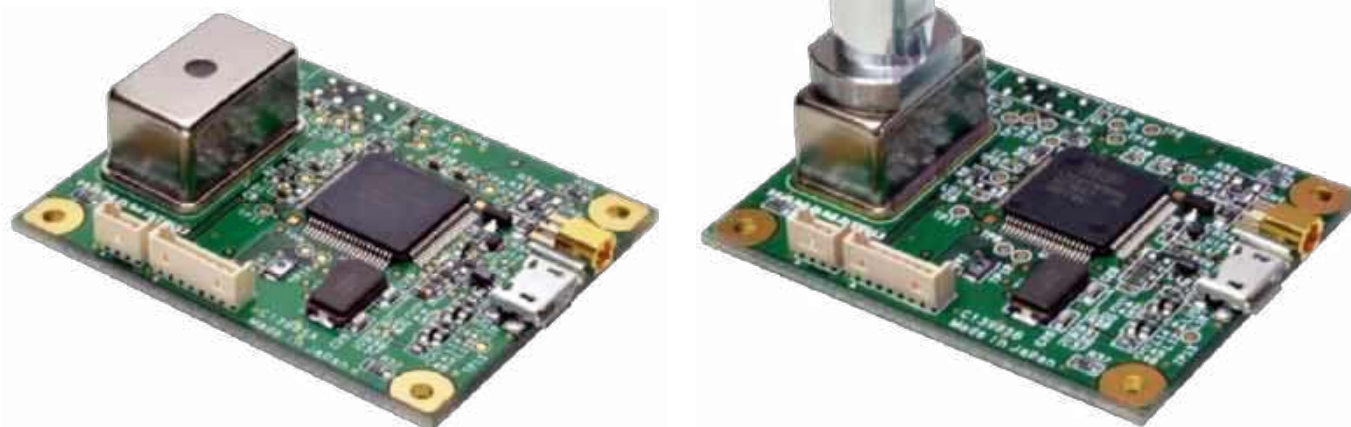
Fotografia 3. Zestawy uruchomieniowe z dwiema wersjami modułu spektrometru
