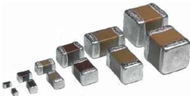
Fotografia 2. Kondensatory MLCC w obudowach SMD [4]
