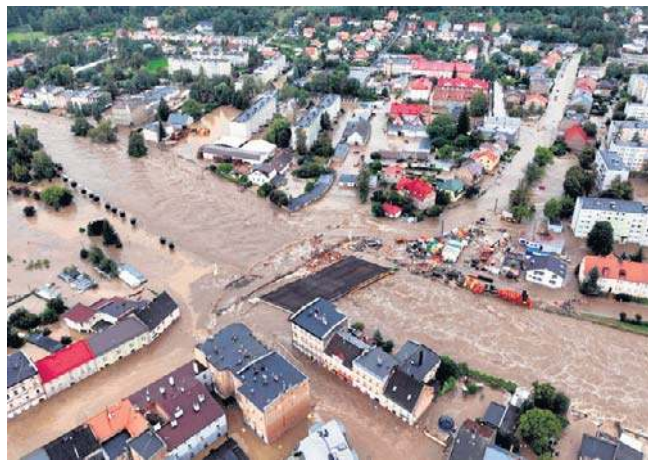
Przez kilkadziesiąt godzin ratownicy próbowali wzmocnić most, obciążając jego przyczółki kamienną kostką
