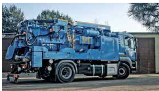
Samochód ciśnieniowo-ssący do obsługi i konserwacji sieci kanalizacji
