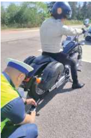
Podczas kontroli wykorzystano miernik poziomu dźwięku, za pomocą którego dokonano pomiarów poziomu hałasu emitowanego przez kontrolowane motocykle
