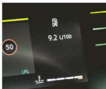
Wzorowo – komputer pokładowy podaje stan paliwa, spalanie i zasięg zarówno dla benzyny, jak też gazu.
