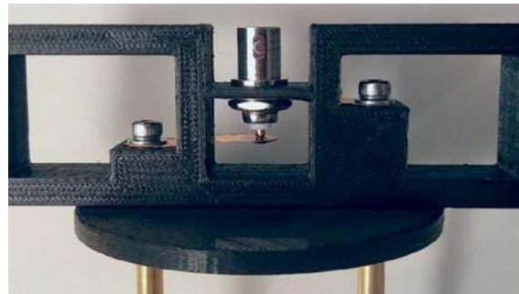
Fot. 3. Połączenie prętów z gniazdkiem BNC
