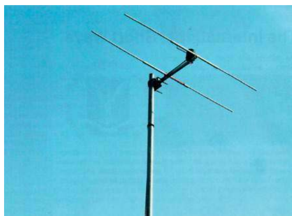
Rys. 5. Szkic anteny HB9CV na pasmo 70 cm
