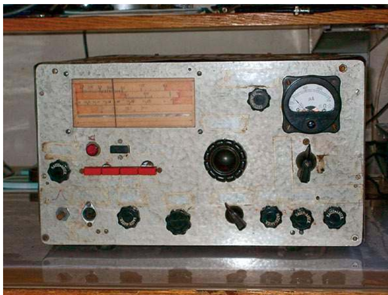
Transceiver CW /SSB (80–10 m) – klubu SP6PAZ – zbudowany przez Stefana SP5DVD, Stanisława SP6DXB oraz Ignaca SP6FIK w latach 1969–1970
