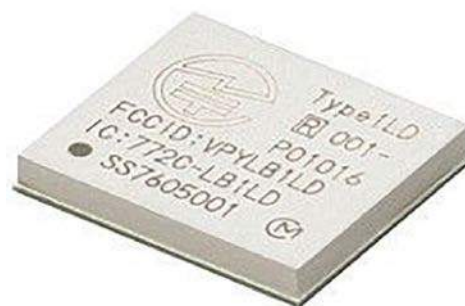
Fotografia 9. Miniaturowy moduł Wi-Fi 1LD-Ayla marki Murata ( https://bit.ly/2ROGxtt )
