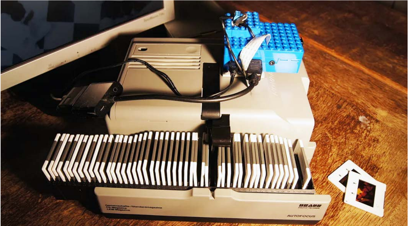
Fotografia 4. Skaner gotowy do pracy i załadowany przezroczkami
