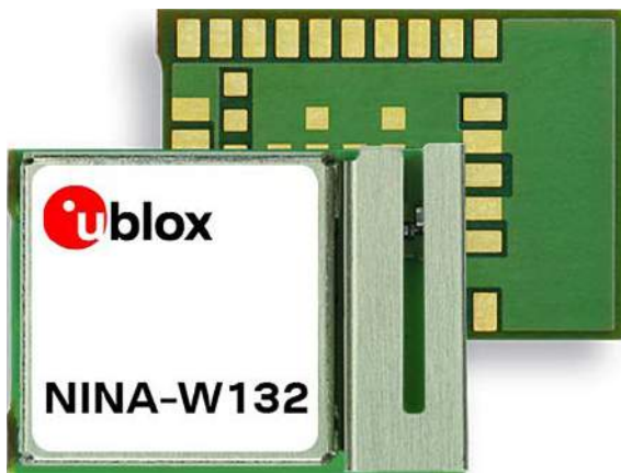
Fotografia 6. Moduł Wi-Fi z serii NINA-W13 w wersji z anteną blaszkową typu PIFA ( https://bit.ly/2QuqApj )
