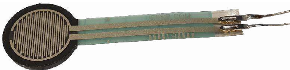
Fotografia 1. Czujnik siły nacisku FSR402
