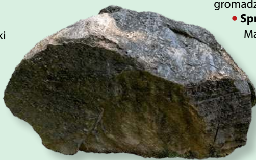
Bazalt to skała wulkaniczna bogata w związki mineralne, np.: tlenki glinu, żelaza i krzemu.
