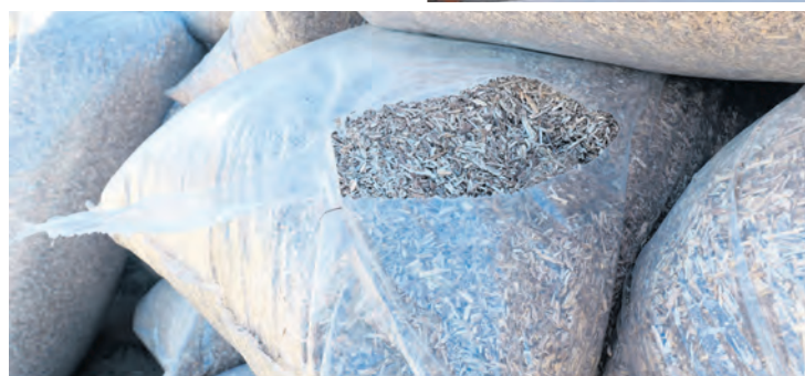
Konopie, oprócz wapna, są głównym budulcem, z którego powstają ściany domu. Kaźmierczakowie mieszankę przygotowują na bieżąco i wiadrami wynoszą na kolejne metry ścian. To żmudna praca wymagająca dużego wysiłku fizycznego. Fot. Piotr Paterski
