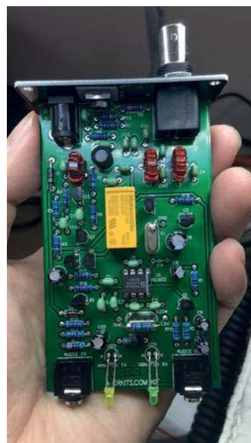
Konstrukcja transceivera D4D na płytce drukowanej
