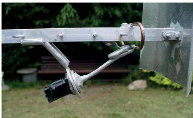
Sposób wykonania wibratora z gniazdem (13 cm)
