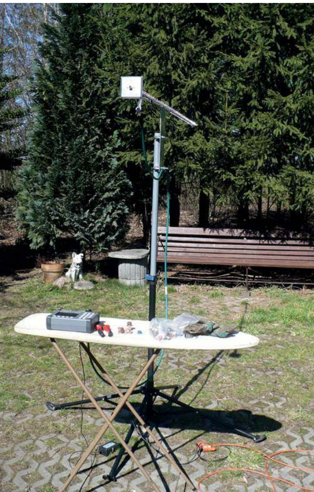
Stanowisko pomiarowe anteny na 13 cm
