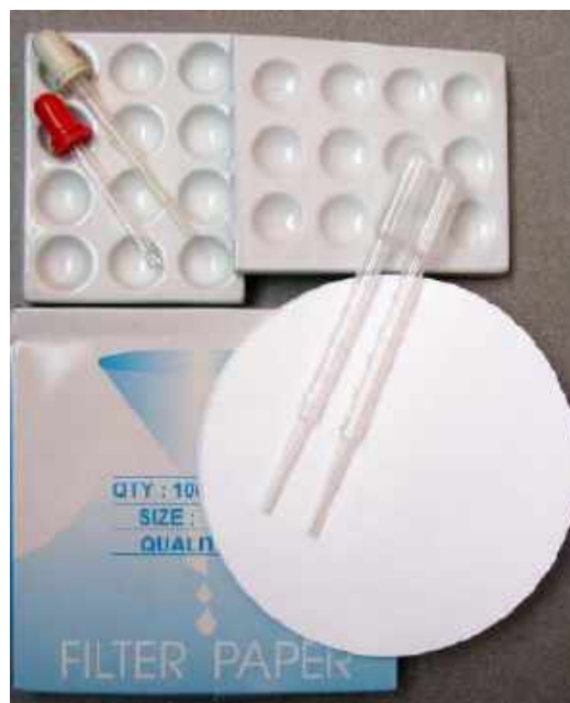
1. Zestaw do analizy kroplowej: płytki porcelanowe z wgłębieniami, bibuła filtracyjna i zakraplacz
