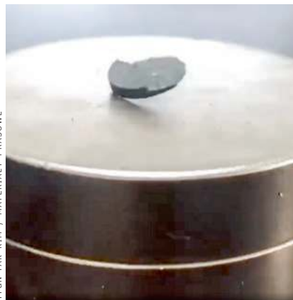
Płytką LK-99 unosząca się nad magnesem. Efekt Meissnera świadczący o nadprzewodnictwie czy diamagnetyzm?
