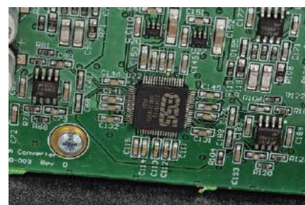
ESS Technology ES9028Pro jest umieszczony nieopodal wyjść analogowych (ścieżka sygnału jest bardzo krótka).
