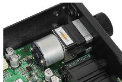
Układ regulacji głośności łączy rozwiązania analogowe i cyfrowe, ale sygnały z wejść analogowych są obsługiwane wyłącznie przez obwody analogowe.
