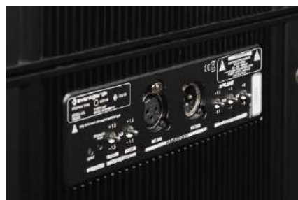
W testowanej parze Duo SD były także zainstalowane wzmacniacze iTron – uruchamiając taką opcję, dostarczamy tutaj sygnał z przedwzmacniacza.
