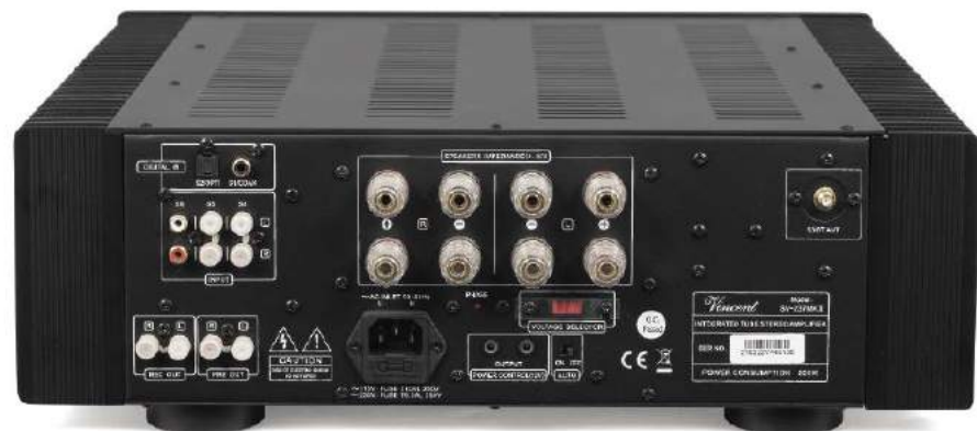
Również do wzmacniacza dostarczymy sygnały cyfrowe, chociaż szkoda, że nie podłączymy gramofonu.
