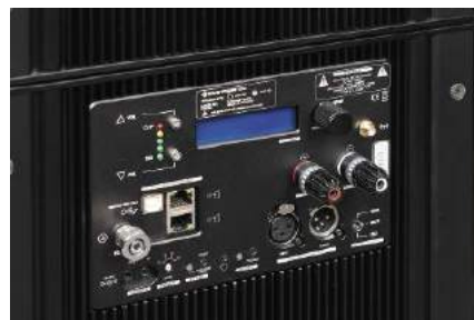
To panel sekcji niskotonowej; po prawej stronie para zacisków WBT, do której podłączamy kabel biegnący z góry, alternatywnie możemy wykorzystać wejście XLR. Na górze mały wyświetlacz pomocny przy regulacji poziomu.
