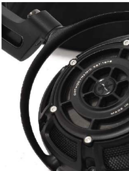
Muszle są zawieszane na dość typowych widelcach i połączone z pałakiem solidnymi przegubami
