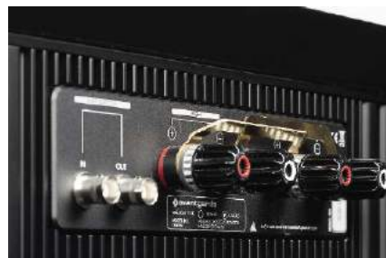
Tutaj podłączamy kabel ze wzmacniacza (do lewej pary zacisków WBT) i długą kablową zworę biegnącą do sekcji niskotonowej (do prawej pary zacisków).
