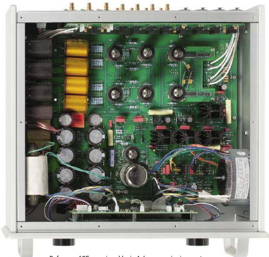
Reference 6SE pracuje w klasie A, bez sprzężenia zwrotnego, ze zbalansowanym torem sygnału.
