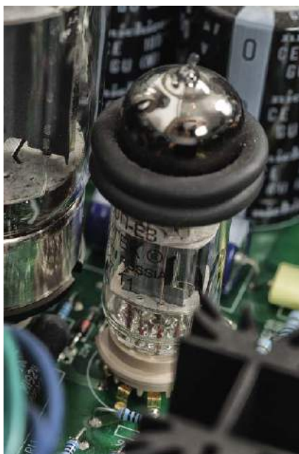
Na lampach 6H30 założono pierścienie tłumiące drgania
