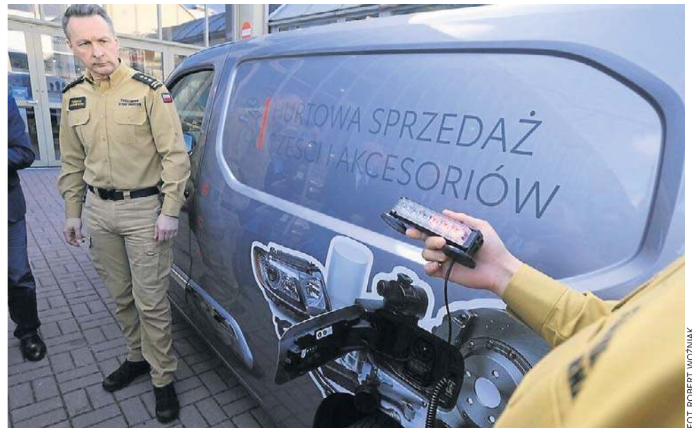
Po podłączeniu wtyczki do portu ładowania samochód zostaje unieruchomiony
