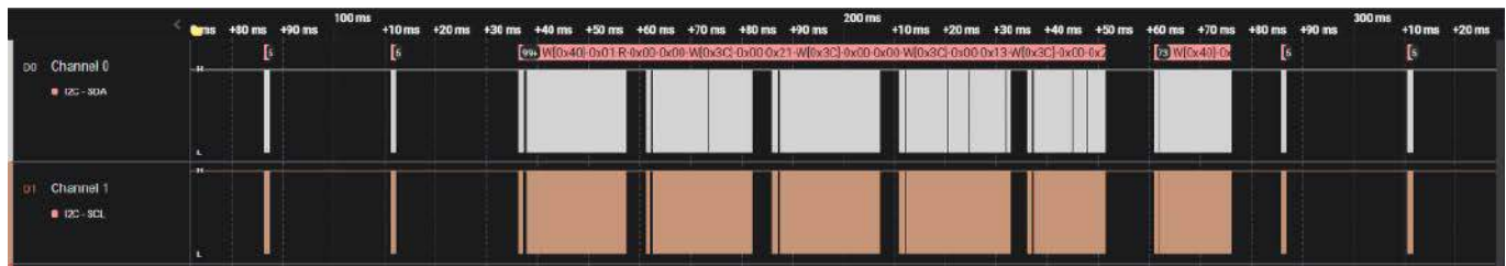
Rysunek 4. Rzeczywiste przebiegi czasowe aplikacji urządzenia miA podczas wykonywania pomiarów prądu i wyświetlania wartości na ekranie OLED zarejestrowane w układzie rzeczywistym za pomocą zaawansowanego analizatora stanów logicznych z funkcją dekodowania protokołów transmisji
