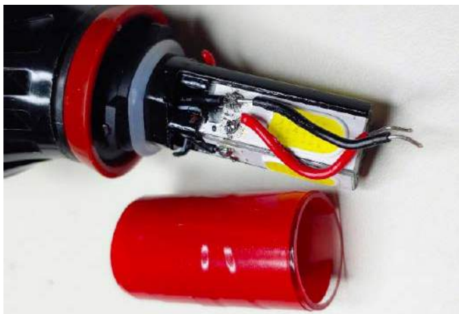
Fotografia 1. Otwarty układ do pomiaru z diodami LED. Zdemonstrowana została szklana rurka, odpowiedzialna za chłodzenie
