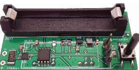
Fotografia 1. Zmontowane urządzenie miA od strony warstwy TOP tuż przed przyłutowaniem wyświetlacza OLED
