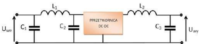
Rysunek 9. Układ redukcji zakłóceń w przetwornicy DC-DC
