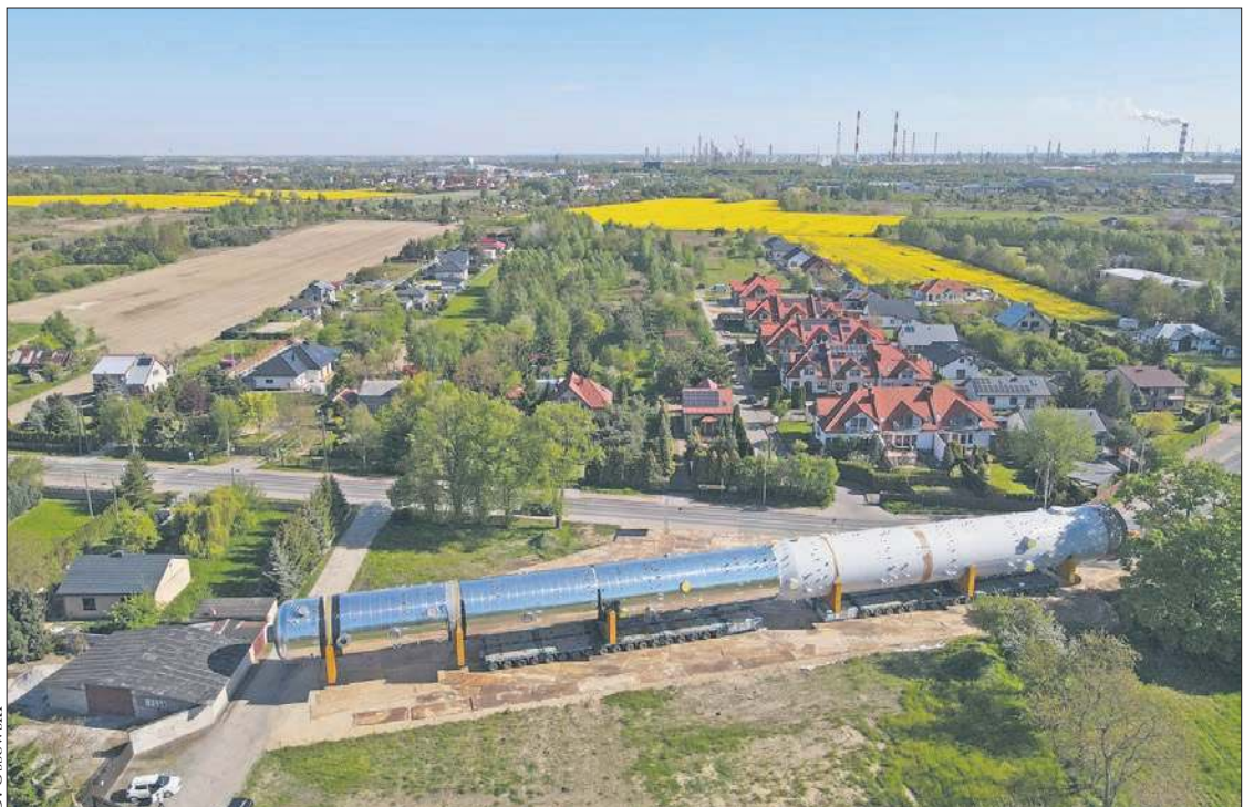
Do przewozu kolumny petrochemicznej wykorzystano 72-osiowy zestaw SPMT - liczący 576 skrętnych kół
