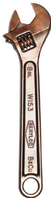
5. Narzędzie z brązu berylowego: twarde, nie iskrzą przy uderzeniu, niemagnetyczne, odporne na korozję
