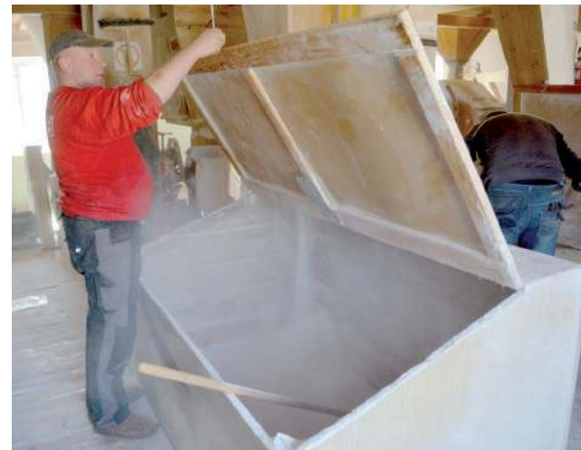
Gotową, idealnie zmieloną mąkę odsiewacz transportuje do drewnianej skrzyni, takiej jak ta na zdjęciu. Urobek, który jeszcze potrzebuje domielenia, odsiewacz kieruje z powrotem na walce
