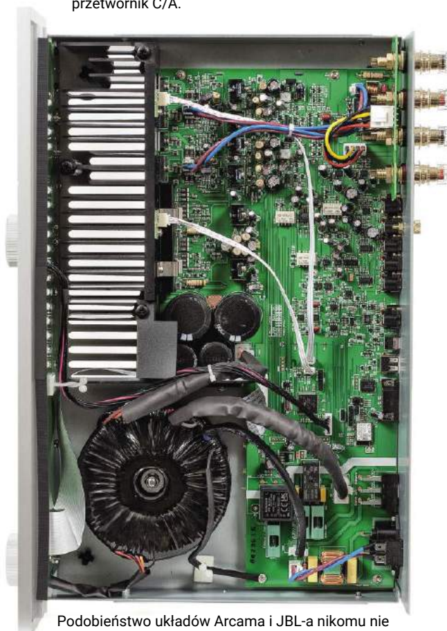
Układ elektroniczny CD350 podzielono na trzy główne moduły – zasilacz, odtwarzacz (płyty i plików) oraz przetwornik C/A.
