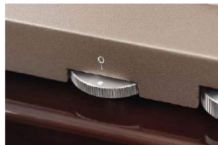
System stroboskopowy uzupełnia pokrętkę do elektronicznej mikrokorekcji obrotów.
