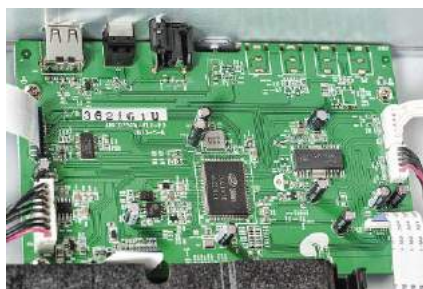
Umieszczona za mechanizmem płytka to sekcja z odtwarzaczem plików wysokiej rozdzielczości (z płyt i USB).
