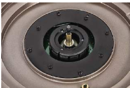
Czarne osłony skomplikowanego systemu cewek napędu bezpośredniego.
