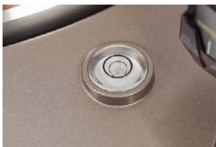
W tym celu zainstalowano na niej poziomnicę.
