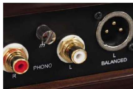
Wyjścia XLR pozwalają wyciągnąć z wkładki MC sygnał zbalansowany.
