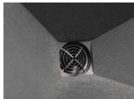
Klipsch dołożył wielką tubę i soczewkę akustyczną w formie kratki wentylatora.
