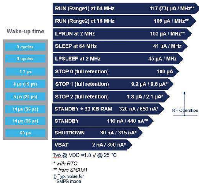
Rysunek 4. Tryby pracy STM32WB wraz z poborem prądu oraz czasem wybudzenia
