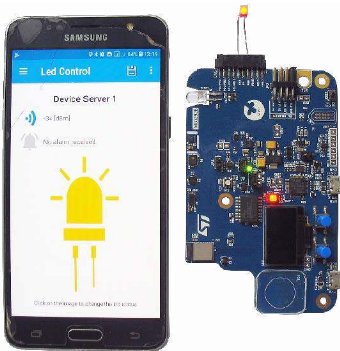
Fotografia 1. Widok działającego systemu BLE (od lewej: zdjęcie aplikacji ST BLE sensor po wysłaniu komunikatu o zapaleniu diody LED, zdjęcie płytki STM32WB5MM-DK z zapaloną diodą LED po otrzymaniu komunikatu
