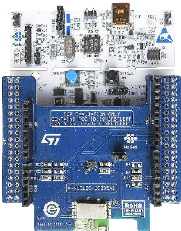
Fotografia 1. Płytkę BLE X-Nucleo-IDB05A1 połączona z modułem Nucleo F-401RE
