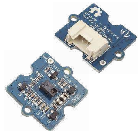
Fotografia 5. Moduł z układem scalonego sensora gestów PAJ7620U2
