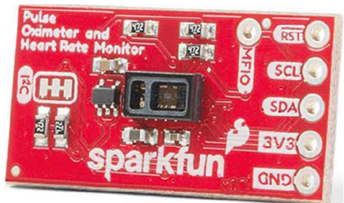
Fotografia 5. Moduł SparkFun SEN-15219 z układem MAX30101 i cyfrowym procesorem biomedycznym MAX32664 ( https://bit.ly/2SEjAan )
