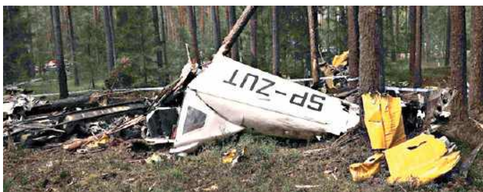
Samolot, ścinając wierzchołki drzew, o godzinie 20.40 zderzył się z ziemią. Nastąpił zapłon paliwa wyciekającego z rozerwanymi zbiornikami
