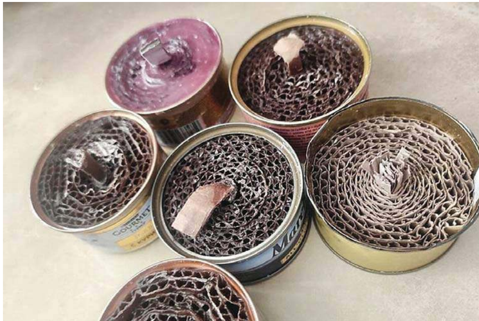
Świeca okopowa składa się z metalowej puszki, tekturowego knota i wkładu, który zalewany jest woskiem
