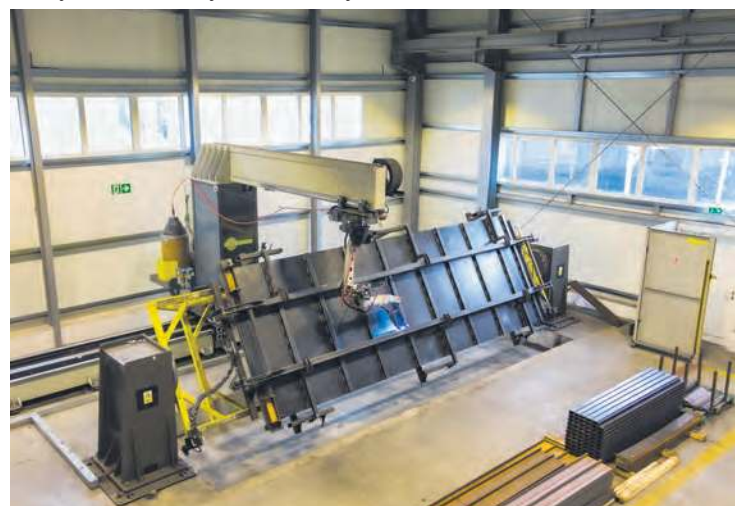
W zakładzie wykorzystuje się nowoczesne technologie, np. roboty spawalnicze. Fot. nadesłane
