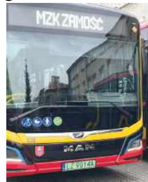
Nowe autobusy to 12-metrowe pojazdy nowej generacji wyposażone w silniki elektryczne o mocy 160 kW.
