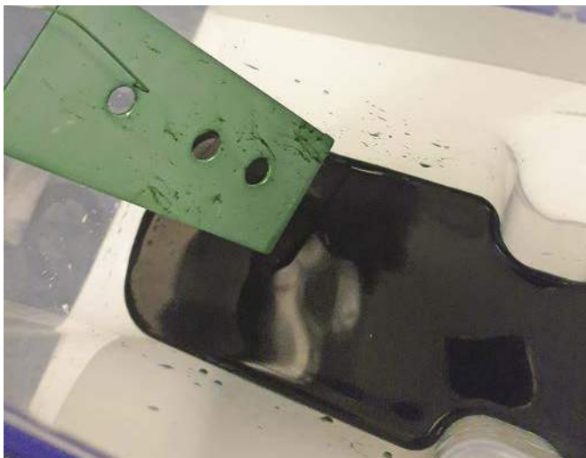
Ta wanna z zielonym barwnikiem działa szczególnie dobrze. Wygląd przedmiotu – po bardzo krótkim zanurzeniu – pokazuje, że nie wymieszaliśmy prawidłowo proszku barwnika z wodą. Przygotowanie jest ważne.
