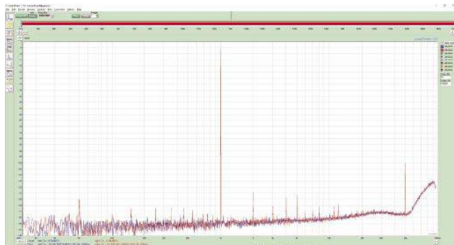
Rysunek 4. Pierwszy test zamkniętej pętli wyjście-wejście, mierzący jakość całego systemu DAC+ADC. Parametry są wciąż znakomite, z nieco tylko wyższymi zniekształceniami harmonicznymi niż w przypadku samego ADC, na poziomie -118 dB (w zaokrągleniu: 0,0001%)
