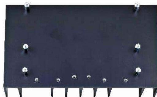
Rysunek 13. Gotowe otwory do montażu tranzystorów mocy
