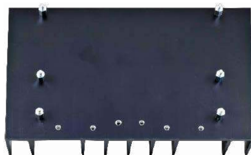
Rysunek 13. Gotowe otwory do montażu tranzystorów mocy
