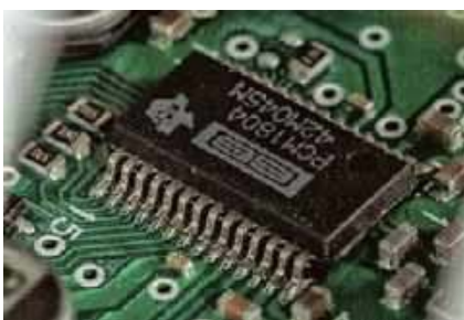
Sekcja analogowa została sprowadzona do absolutnego minimum, ponieważ sygnał jest konwertowany niemal natychmiast do postaci cyfrowej. Za te operacje odpowiada układ Texas Instruments.
