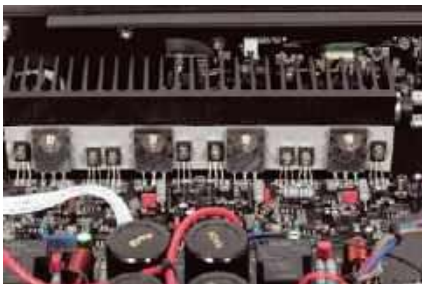
Końcówki mocy z firmową techniką sprzężeń zwrotnych SoundEngine2, dzięki której Hegel osiąga znakomite parametry.
