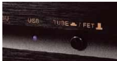
DAC-7 daje do wyboru dwa tryby pracy sekcji analogowej – lampowy i półprzewodnikowy.
