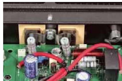
Końcówka mocy to układ w klasie AB z jedną parą wydajnych tranzystorów Sankena.
