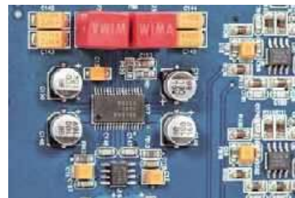
Wobec zapowiadanego zaawansowanego systemu regulacji głośności zaskakuje obecność popularnego scalaka NJR MUSES.
