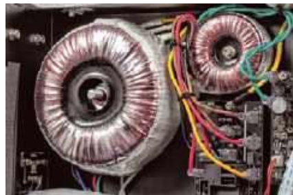
Układy cyfrowe mają niezależny zasilacz.
