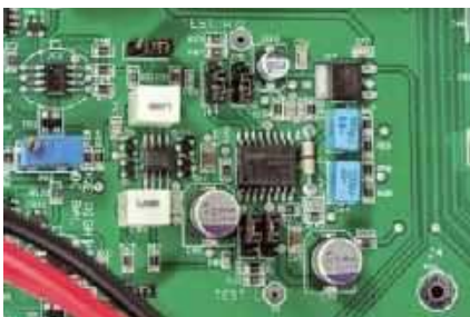
Regulator głośności ma formę scalonego tłumika.
