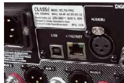
W sekcji cyfrowej błyszczy jak zwykle wejście USB-DAC, które przyjmie tutaj sygnały PCM 32/384 oraz DSD256.
