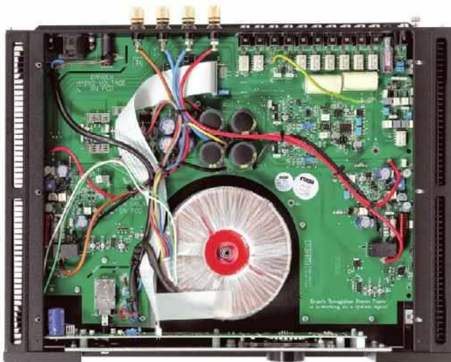
Układ audio skoncentrowano na jednej płytce drukowanej, nowoczesna regulacja głośności pozwoliła skrócić ścieżkę sygnałową, jednak ustalenie bardzo wysokiej czułości obniżyło odstęp od szumu.
