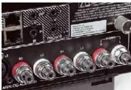
Wśród wejść analogowych największe wrażenie robi phono z regulowanymi parametrami dla wkładek MM i MC.
