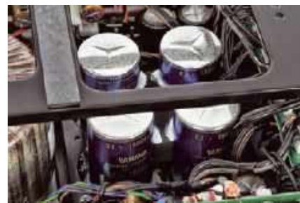
W zasilaczu obok sporego transformatora toroidalnego przygotowano dużą pojemność filtrującą (łącznie 72 000 µF).
