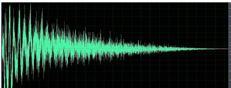
Rysunek 1. Sygnał z syntezatora Roland TR909 naśladujący uderzenie w werble – zwróć uwagę na dużą zawartość szumu
