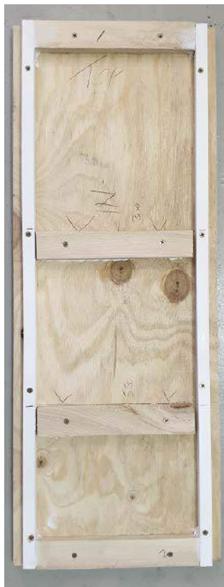
Rysunek 17. Panele subwooferów są wycięte z trzech arkuszy sklejki o wymiarach 600×1200 mm. Podobnie jak w przypadku monitorów, można przeciąć dwa arkusze przez środek. Aby nie trzeba było kupować czwartego arkusza na jeden panel przedni, ostatni element jest wykonany z jednego z odciętych arkuszy głośników półkowych (patrz rysunek 13, w poprzednim numerze EdW)
