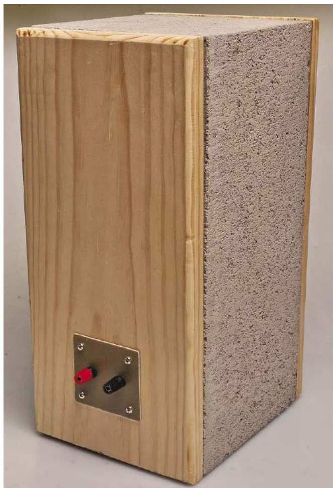
Podobnie, ukończony subwoofer, tutaj widziany od tyłu, aby pokazać małą samodzielnie wykonaną płytkę z laminatu PCB mieszczącą zaciski podłączeniowe
