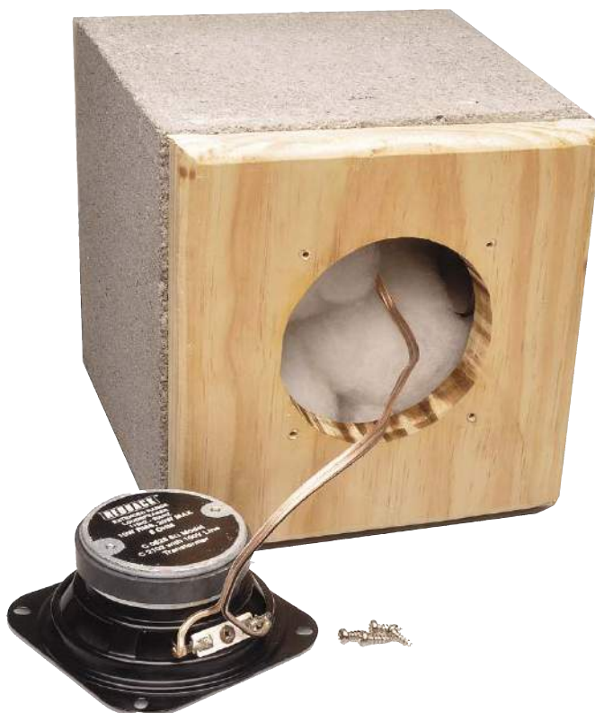
Widok z przodu pokazujący przedni panel przyklejony do pół-pustaka i watę akustyczną wewnątrz. Aby cztery śruby nie wyróżniały się tak bardzo, można pomalować je na czarno
