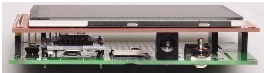
Kolejny widok na sposób współpracy naszej płytki z modułem ekranu dotykowego LCD – po prostu podłącza się ekran do 14-stykowego gniazda żeńskiego (CON1) skrajnie po lewej stronie i 4-stykowego gniazda (CON1A) po prawej. Zasilanie odbywa się przez gniazdo DC (CON3); obok znajduje się gniazdo karty microSD (CON2) z gniazdem USB pod modułem Wi-Fi (po lewej).
