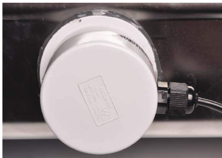
Oto przetwornik przyklejony do pojemnika myjki (w tym przypadku jest to taca kuchenna ze stali nierdzewnej). Aby przykleić czoło przetwornika do boku pojemnika, użyliśmy dwuskładnikowego kleju epoksydowego „J-B Weld”, który naszym zdaniem klei mocniej niż jakikolwiek inny. Możesz zauważyć przezroczysty neutralnie utwardzany kit silikonowy użyty w celu przyklejenia kołnierza obudowy z PCW do boku pojemnika z płynem do czyszczenia.
