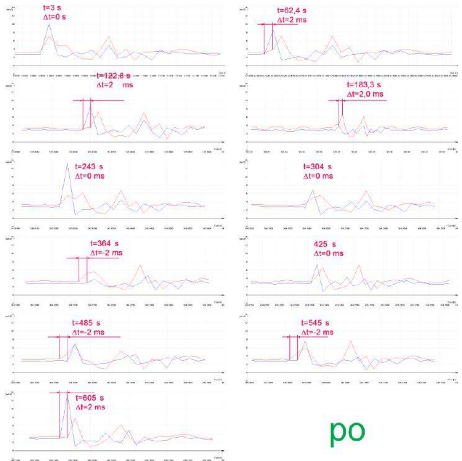
Rysunek 12. Synchroniczne pomiary przebiegów z dobraćnymi rezonatorami
