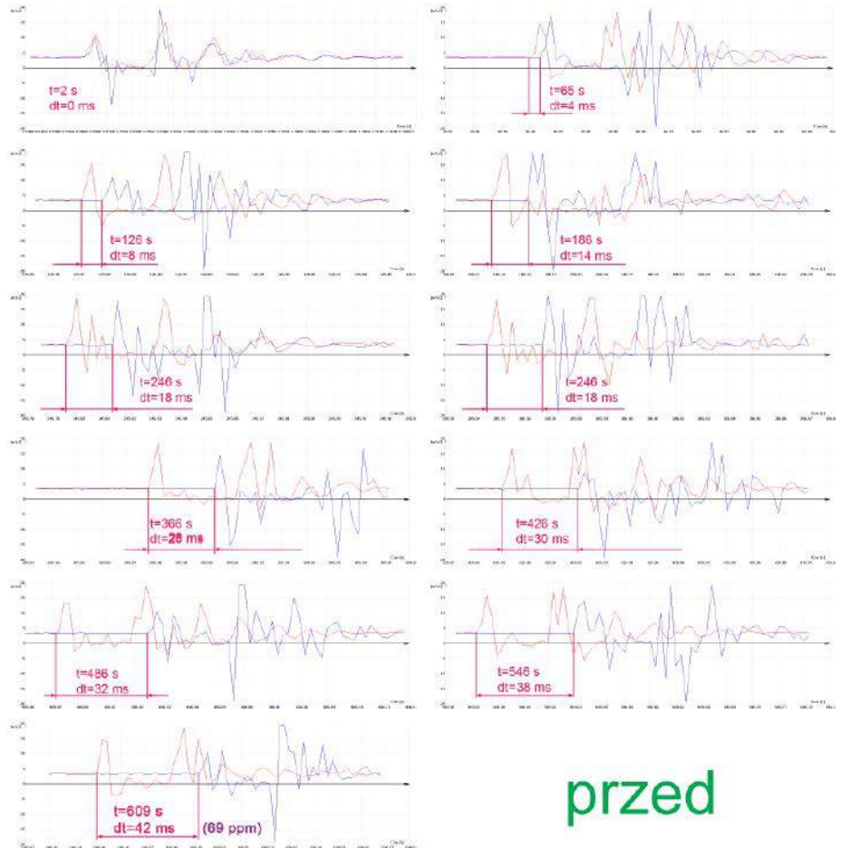
Rysunek 11. Synchroniczne pomiary przebiegów z losowo montowanymi rezonatorami
