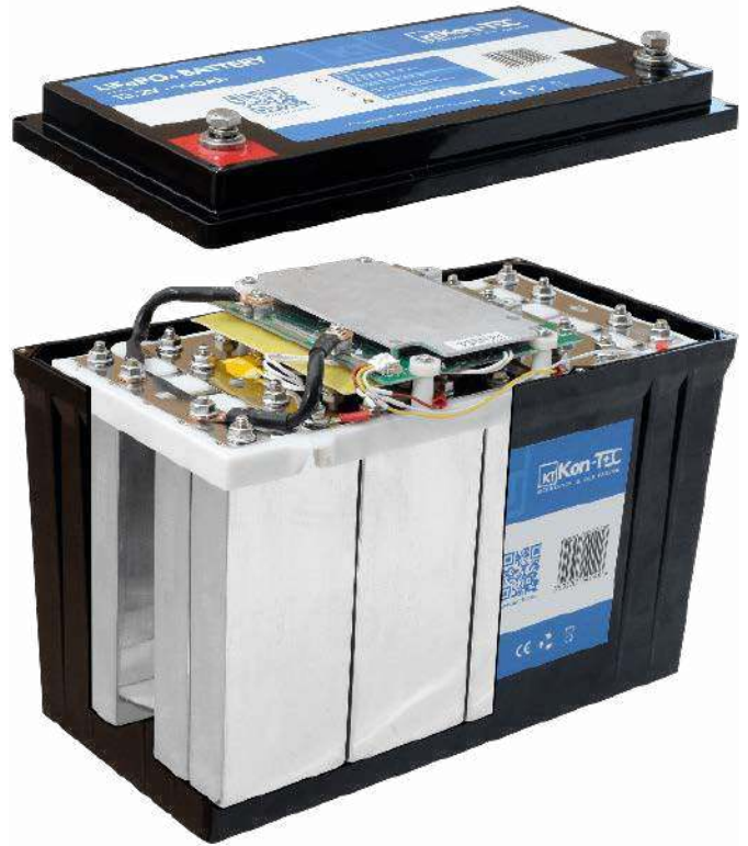
Fotografia 3. Przykładowy akumulator LiFePO4 z prostym układem BMS oferowany przez Kon-TEC
