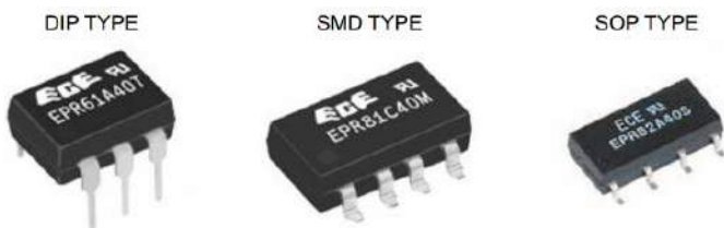
Fotografia 2. SSR w miniaturowych obudowach od firmy ECE
