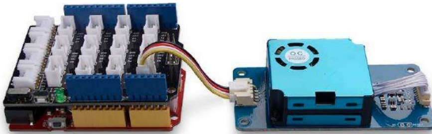
Fotografia 1. Moduł podłączony do Arduino przez płytkę Grove Base Shield
