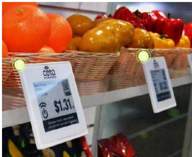
Fotografia 4. Inteligentna metka z technologią ładowania bezprzewodowego Cota [2]
