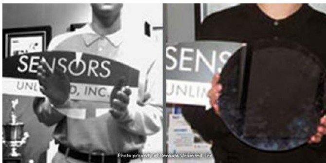
Fotografia 4. Przejroczysty w podczerwieni substrat krzemowy – materiał ten nie nadaje się do produkcji sensorów IR, ale może być użyty do wykonania optyki do systemów termowizyjnych. Po lewej widoczne jest zdjęcie w podczerwieni, a po prawej stronie to samo, ale wykonane zwykłym aparatem w świetle widzialnym
