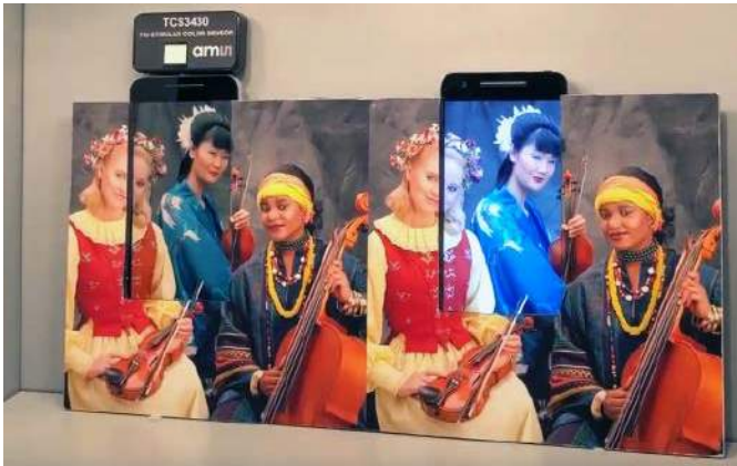
Fotografia 6. Przykład zastosowania czujnika TCS3430 do kompensacji temperatury barwowej otoczenia w celu uzyskania efektu, określanego jako paper-like display. To samo zdjęcie zostało wydrukowane dwukrotnie, po czym wycięto w nim otwór, w którym umieszczono smartfona. Po lewej stronie widać efekt zastosowania czujnika TCS3430 – balans bieli na wyświetlanej części fotografii został tak dopasowany do ciepłego światła otoczenia, że obraz niemal „zlewa się” z wydrukiem. Po prawej stronie analogiczny test, ale bez użycia kompensacji ( https://t.ly/9dUXX )
