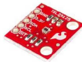
Fotografia 2. Moduł „pasywnego” czujnika koloru, bazujący na układzie ISL29125 – sensor może rejestrować światło padające prosto ze źródła lub odbite od badanej powierzchni, jednak nie zawiera własnego oświetlacza ( https://t.ly/5mLDE )
