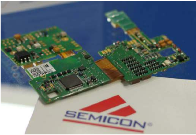
Fotografia 13. Płytki w technologii Flex-Rigid, produkowane przez Semicon. Płytki są po montażu pokryte powłoką konformalną, która zabezpiecza je przed wilgocią itp.
