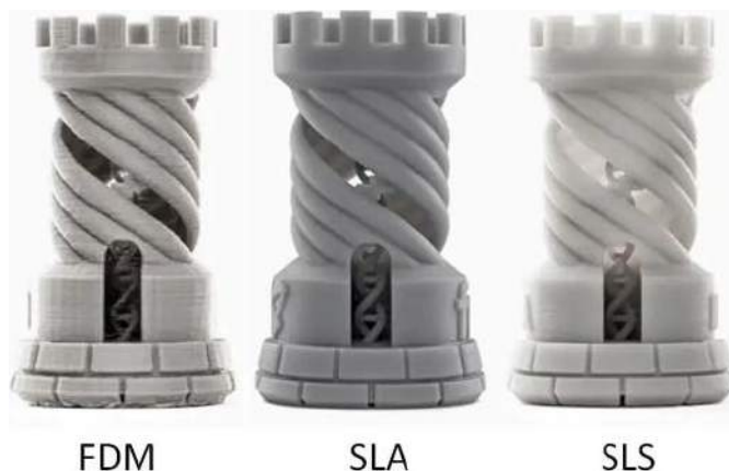
Rysunek 2. Przykładowe wydruki z drukarek FDM (po lewej), SLA (w środku) i SLS (po prawej)
