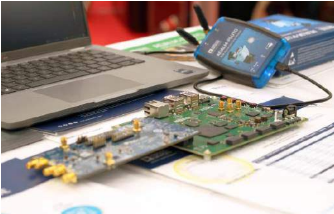
Fotografia 2. Płytki deweloperskie DataStorm DAQ wraz z modułem z radiowym front-endem na bazie ADR9002 (na pierwszym planie) oraz modułu ADALM-PLUTO podłączony do komputera (na drugim planie)
