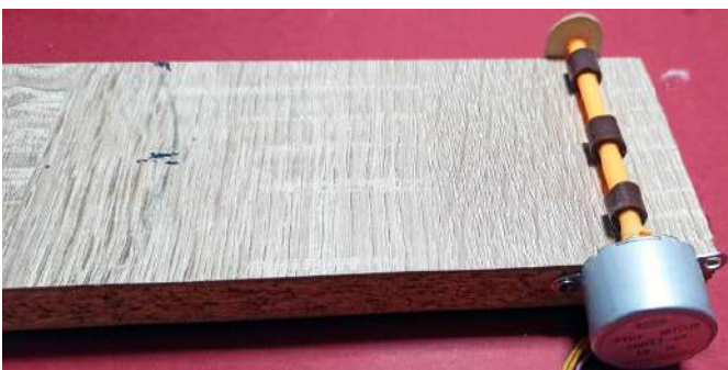
Fotografia 1. Zdjęcie z montażu urządzenia – silnik przesuwający taśmę papierową
