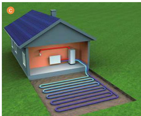
➦ Pompa może czerpać ciepło z – powietrza (a); gruntu z sondami pionowymi (b); gruntu z kolektorem poziomym (c); wód podziemnych (d). DANFOSS
