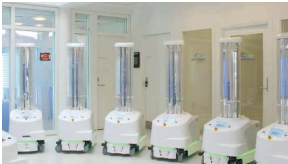
Tak wyglądają roboty do dezynfekcji. Każde z tych urządzeń jest w pełni autonomiczne, po wstępnym zaprogramowaniu ich obsługa nie jest już skomplikowana. Z jednej strony zapewniają walkę z patogenami, z drugiej - ograniczają koszty, a także czas
