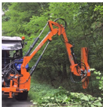
Głowica z pilarką tarczową w trakcie pracy.
