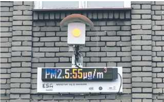
Również czujka powietrza zamontowana na budynku II LO w Chełmie w ubiegłym tygodniu przez większość czasu wskazywała przekroczenie stężenia pyłów i świeciła na żółto, a momentami nawet na czerwono
