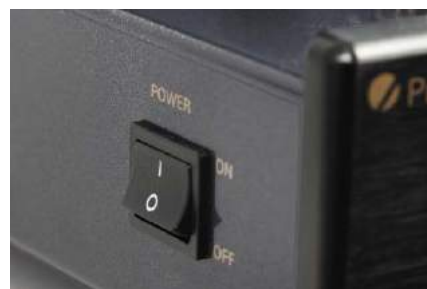
Włącznik zasilania umieszczono na bocznej ścianie.
