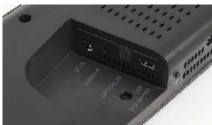
Złącze USB pełni, podobnie jak w większości soundbarów, tylko funkcję serwisową.
