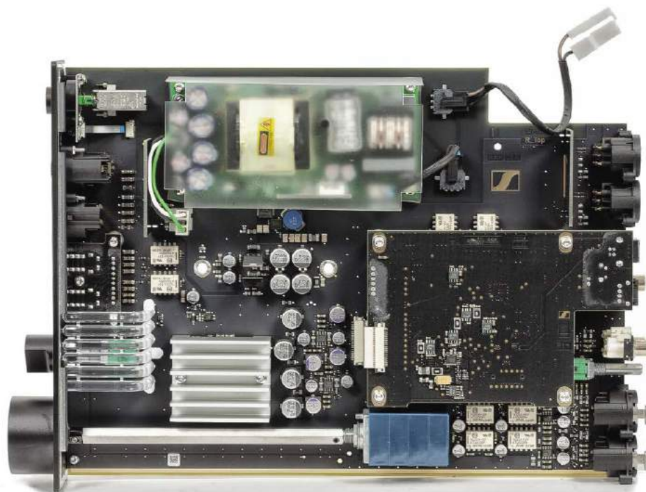
Układ elektroniczny jest rozbudowany i uporządkowany, widać trzy główne bloki: sekcję analogową, cyfrową i zasilacz.
