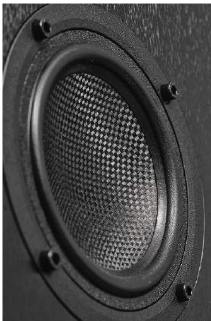
Sferyczna membrana to również w Magico nowość, związana z aluminiowym plastrzem miodu w roli środkowej warstwy sandwicz.
