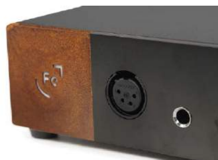
Słuchawki możemy podłączyć do dwóch wyjść: klasycznego tzw. dużego jacka i do wyjścia zbalansowanego.
