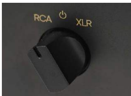
Przełącznik wejść jest jednocześnie włącznikiem zasilania (w pozycji centralnej urządzenie przechodzi w tryb czuwania).
