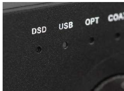
Inna dioda sygnalizuje strumień DSD.
