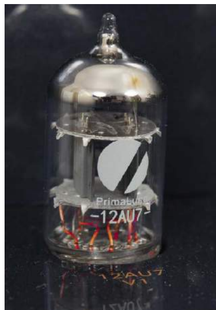
Podwójne triody 12AU7 mają oznaczenia firmy PrimaLuna.
