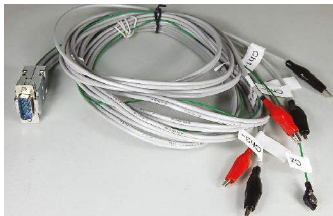
Na tym zdjęciu mamy sondy własnej roboty wykonane z użyciem klipsów-krokodylków i dobrej jakości dwużyłowych kabli w ekranie, działają równie dobrze za ułamek ceny oryginalnych. Nie zapomnij o nalepkach-etykietach z naniesionymi numerami kanałów
