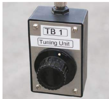
Rysunek 7. Umieszczenie potencjometru strojeniowego w małej skrzynce (połączony kablem) poza anteną znacznie ułatwia strojenie Theremina.
