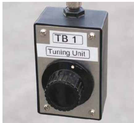
Rysunek 7. Umieszczenie potencjometru strojenieowego w małej skrzynce (połączony kablem) poza anteną znacznie ułatwia strojenie Theremina.
