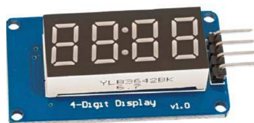
Rysunek 1. Moduł LED TM1637
