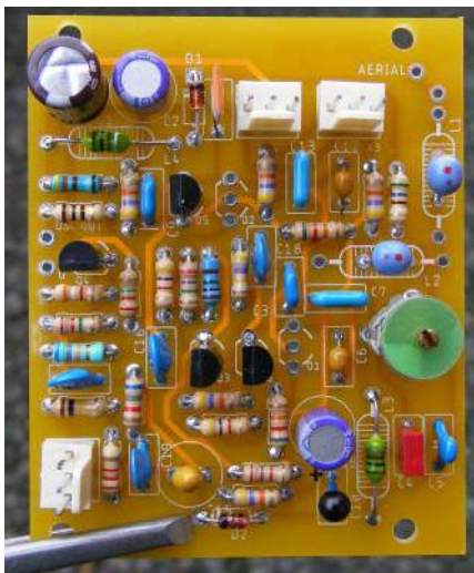
Rysunek 5. Płytką drukowaną wysokości tonów – właściwie jest to Theremin jedynie z prostym strojeniem (ang. pitch-only) na jednej płytce.
