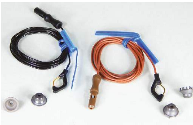
Zdjęcie pokazuje fabryczne elektrody wraz z kablami łączącymi je z elektroencefalografem; o ile same elektrody nie są drogie, to już porządnie ekranowane kable łączące, wręcz przeciwnie.
