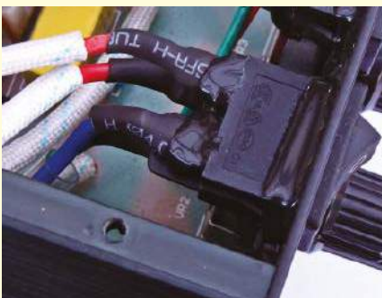
Rysunek 5.19. Dodatkową izolację należy stosować na przewodach przenoszących napięcie sieciowe AC.
