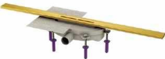
Odpiyw szczelinowy ze stali szlachetnej V4A jest dostępny w różnych kolorach i długościach. Można go dowolnie przedłużyć, przycinać, a także zamontować w narożu. KESSEL
