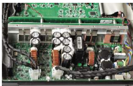
Duńska firma Pascal Audio jest dostawcą kompletnego (wraz z impulsowym zasilaczem) modułu wyjściowego.
