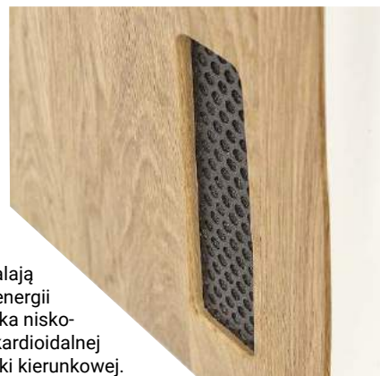
Duży przetwornik na froncie jest filtrowany górnoprzepustowo przy ok. 100 Hz; poniżej pracują głośniki niskotonowe zainstalowane na tylnym panelu.
