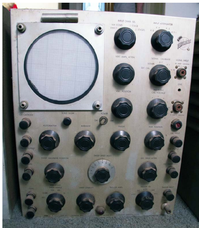
Rysunek 4. Tektronix 511 (1947) – pierwszy oscyloskop ze stabilnym wyzwalaniem ( triggered sweep ). Pasma 10 MHz, masa ok. 30 kg, cena 795 USD. Źródło: https://w140.com/tekwiki/wiki/511
