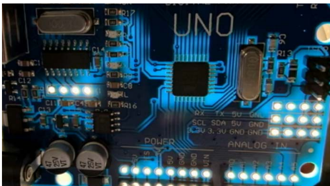
Zdjęcie płytki Arduino Uno podświetlonej od tyłu – widoczne przerwy w płaszczynach miedzi na obu warstwach, będące skutkiem copper pour (zalania miedzią) wykonanego po routingu
