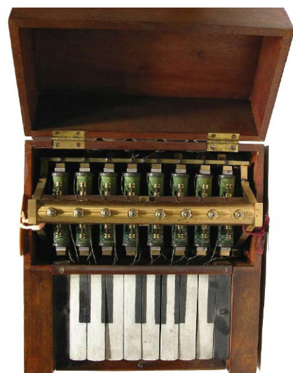
Rysunek 27. „Muzyczny telegraf” Elishy Graya z 1876 r. Zróżdło: https://americanhistory.si.edu/collections/search/object/nmah_703475
