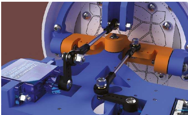
Rysunek 4. Każde animatroniczne oko (u góry) jest sterowane przez dwa serwowymiar 9 g (zdjęcie: Steve Manley)
