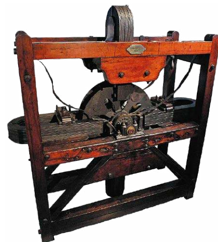
Rysunek 21. Generator elektryczny Woolricha – pierwszy generator energii do celów przemysłowych. Źródło: https://www.wiki/78sc (CC-BY-SA-4.0)
