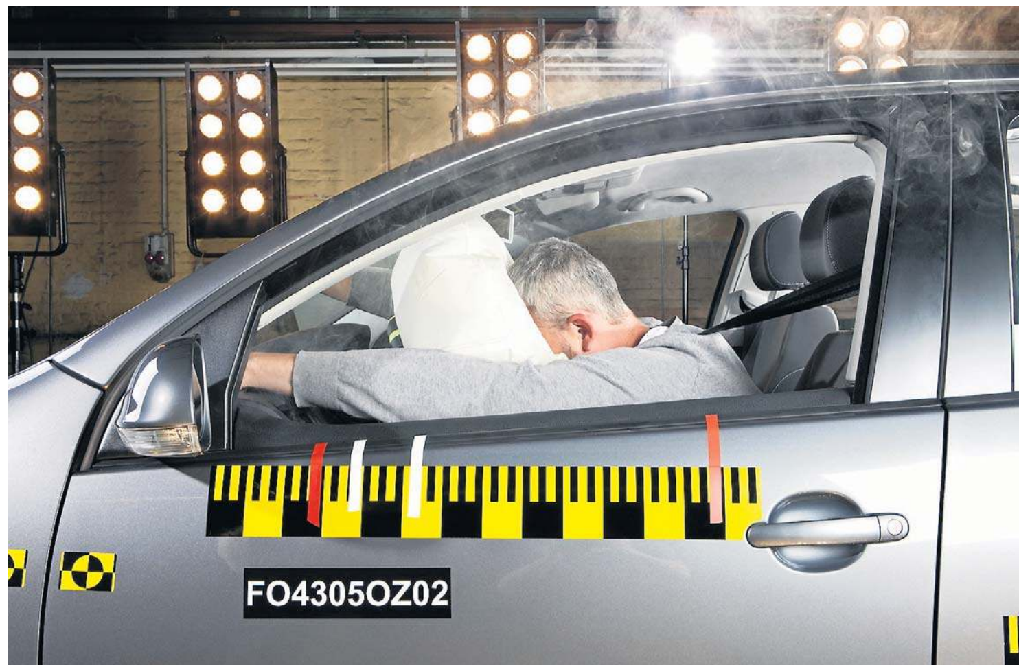
Poduszki, odpowiednio złożone i pokryte talkiem, ukryte są pod cienkimi warstwami tworzywa sztucznego. Oznaczone są skrótami SRS, SRS-Airbag lub Airbag, widocznymi w miejscach montowania. Po wystrzeleniu muszą zostać wymienione na nowe
