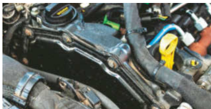
PASEK ROZRZĄDU pracujący w oleju wymusza naprawę częste wymiany środka smarnego.
