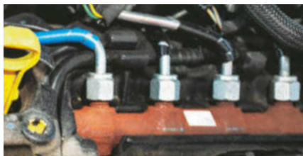
UKŁAD WTRYSKOWY w 2.0 EcoBlue na początku był wadliwy. Ale nawet poprawione wtryskiwacze są dość delikatne i niezbyt tanie.
