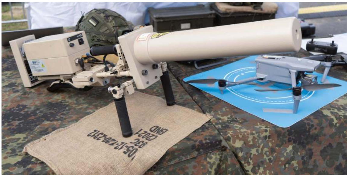
Lekki karabin antydronowy Effektor HP47, selektywnie zaskócający sygnały sterujące oraz połączenia GPS
