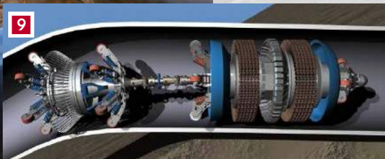
5. Wczesne ręcznie układane rurociągi; 6. Elektryczne łukowe spawanie rurociągu; 7. Operacja Pluto – układanie rur do ropociągu na dnie kanału La Manche rozwijanych z pływającego na morzu bębna; 8. Inspekcja radiograficzna; 9. Wizualizacja jednego z rodzajów urządzenia typu smart pig
